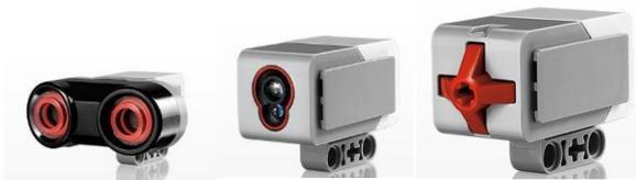
Датчик касания. Ультразвуковой датчик. Датчик цвета.
