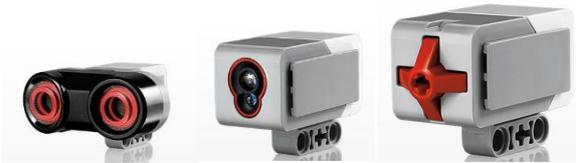
Датчик касания. Ультразвуковой датчик. Датчик цвета.
